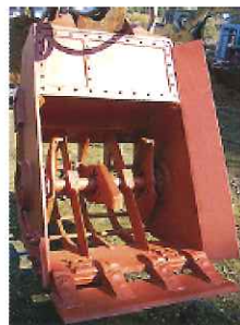
攪拌促進ブレード付 攪拌混合窓地
