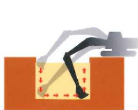
バケットに設置された電気比抵抗値測定センサーによる攪拌混合度の確認
