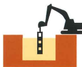
任意の位置、深度で 未固化試料採取が可能
